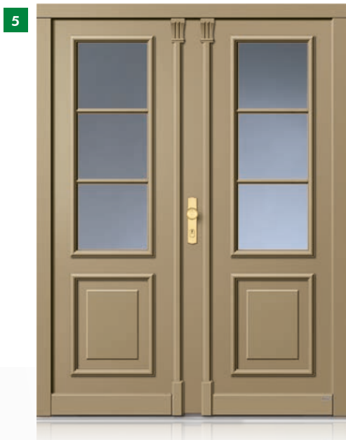
5 signum 7660 Farbe: graubeige (RAL 1019), Klarglas Griff: Art. 250016 Sonderausstattung: Kopfstücke, Wetterschenkel Art. 51
